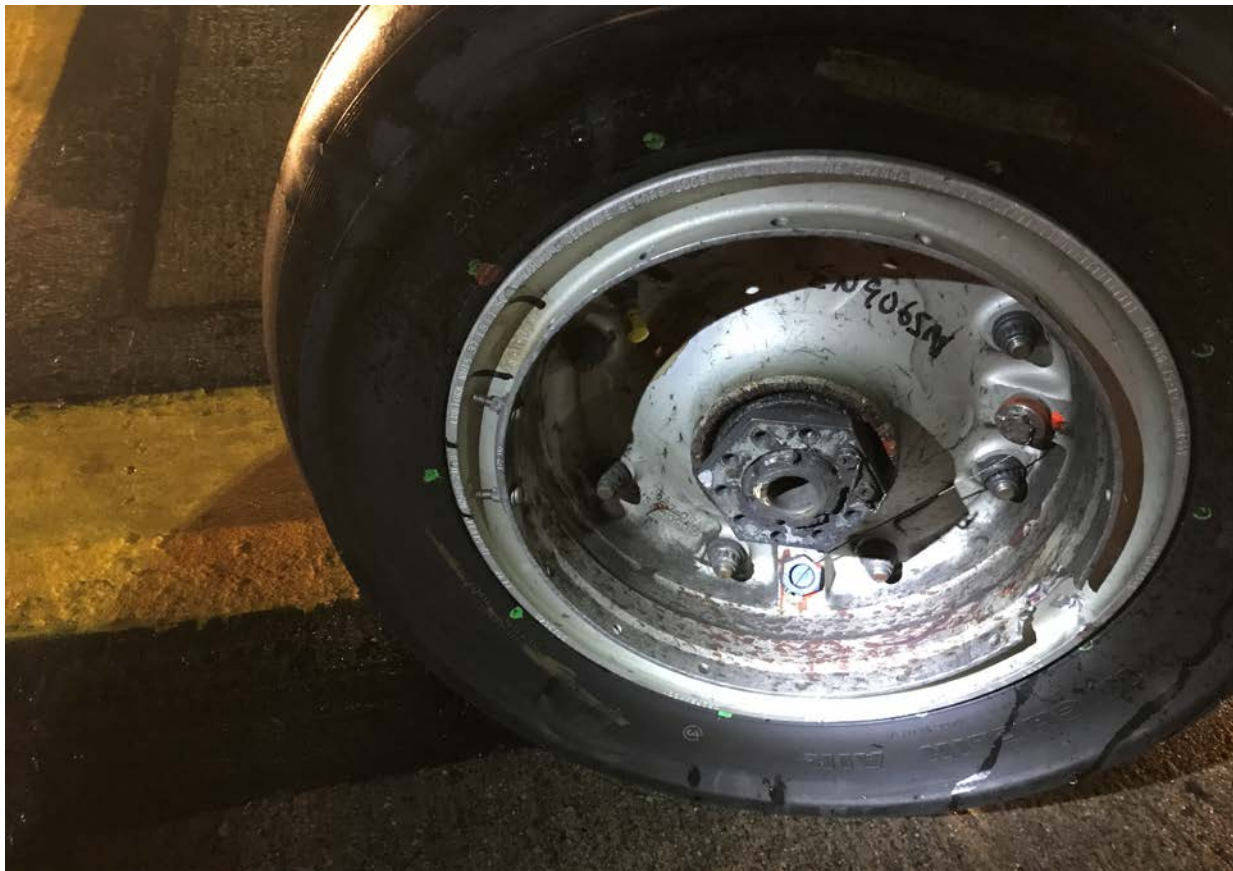
Roue droite endommagée du train avant
