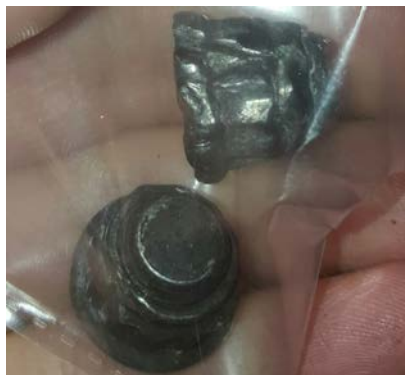
Écrous cisailés de boulons de liaison de roue du train principal
